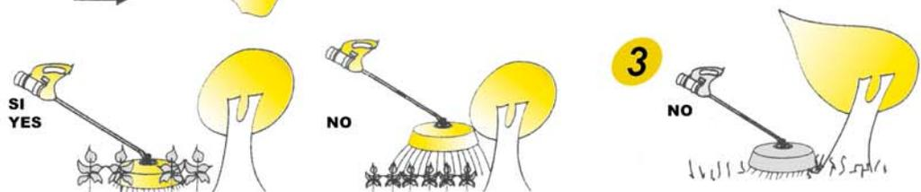
**2** 2. Il disco di rotazione deve funzionare in posizione orizzontale e sotto il livello delle foglie della coltivazione.
