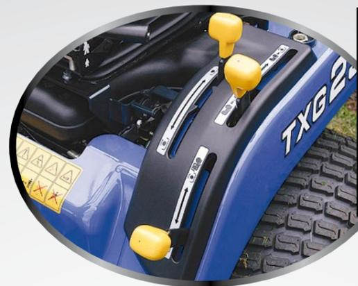
Le prese di forza posizionate nella parte ventrale e posteriore si inseriscono meccanicamente tramite una leva e sono completamente indipendenti dalla trasmissione. La presa di forza anteriore è un'estensione di quella ventrale e in abbinamento al sollevatore, può comandare una grande varietà di attrezzi frontali.
