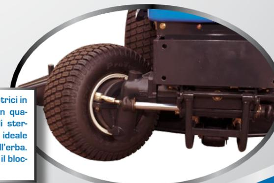
Anche con le quattro ruote motrici in azione (peraltro disinseribili in qualunque momento), il raggio di sterzata risulta davvero stretto; ideale per le operazioni di sfalcio dell'erba. Di serie, inoltre, un pedale per il bloccaggio del differenziale.
