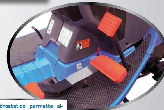
Il pedale idrostatico permette all'operatore una migliore gestione della velocità del mezzo e una guida più morbida in tutte le situazioni di lavoro. L'immagine evidenzia la pulizia e l'ampiezza dello spazio a disposizione per le gambe dell'operatore.
