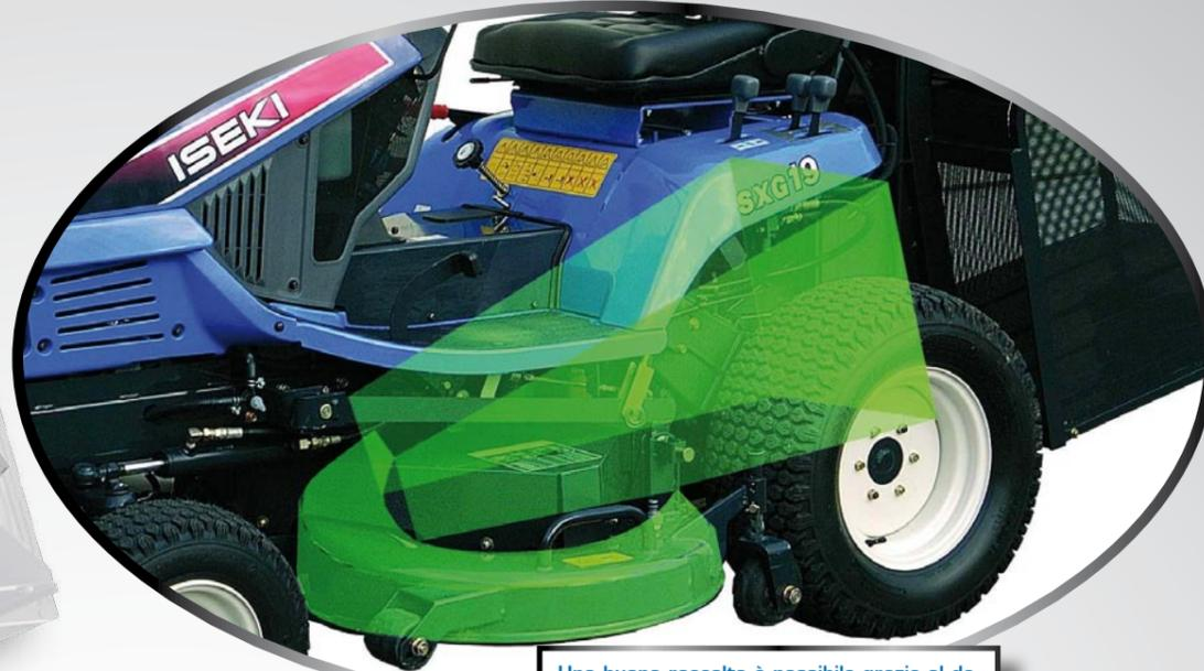
Una buona raccolta è possibile grazie al deflusso aerodinamico. Il sistema adottato da Iseki per la serie SXG è perfetto: lame efficienti, apparato di taglio profondo, scarico diretto e tunnel ampissimo permettono di affrontare qualunque condizione di lavoro in totale scioltezza.
