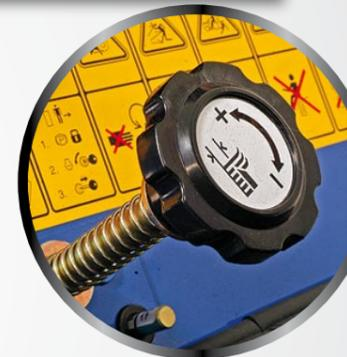
L'altezza di taglio può essere variata con precisione millimetrica direttamente dal posto di guida. Per agire invece sulla capacità di flottazione dell'apparato di taglio è possibile regolare le routine.
