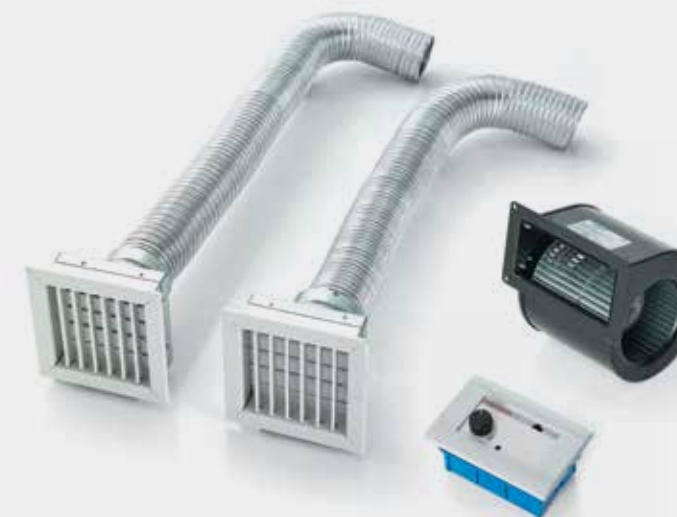
FFA 6063 KIT CALORE: composto da ventola e scambiatore d'aria, centralina con sonda a 5 velocità, due tubi flessibili e due bocchette multidirezionali. Il tutto già montato sul forno dall'azienda. Disponibile sui modelli ad incasso CAST 57 / 80 e INCQV 80x54 / 80x45 / 57x45 HITZE KIT: bestehend aus Ventilator und Luft-Wärmetauscher, 5-Gang-Einheit mit einer Sonde, zwei Schläuche und zwei multi-direktionalen Düsen. Alles ist bereits in dem Ofen von der Firma montiert. Auch für CAST-Modelle 57 cm / 80 cm und INCQV-Einbauöfen 57 cm, 80 cm und 80x54 cm erhältlich.
